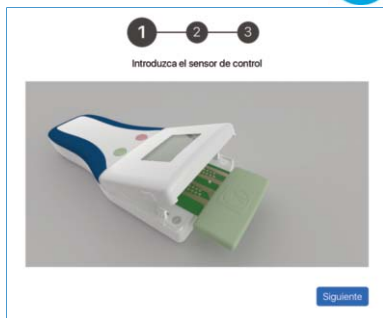
Figura 20: Primer paso del test del sensor: inserte el sensor de prueba en el dispositivo
